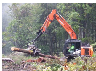
プロセッサ造材 (下北署：青森県むつ市)
