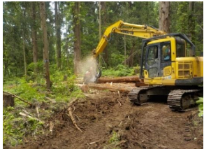
林業機械による造材作業 (秋田署：秋田県仙北市)
