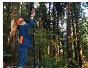
地上型3Dレーザによる測定 (三八上北署：青森県十和田市)
