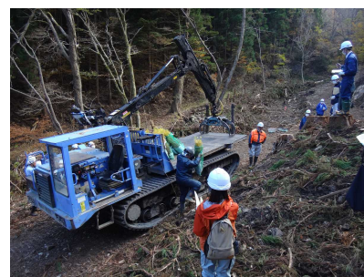
一貫作業現地検討会 フォワーダを活用した苗木運搬 (宮城北部署：宮城県南三陸町)
