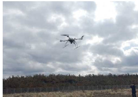
風雨時でも調査可能な災害用ドローン
