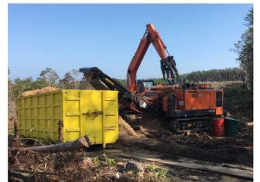
移動式チップパーを用いた林地残材の有効利用
