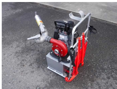
軽可搬式消火ポンプ
