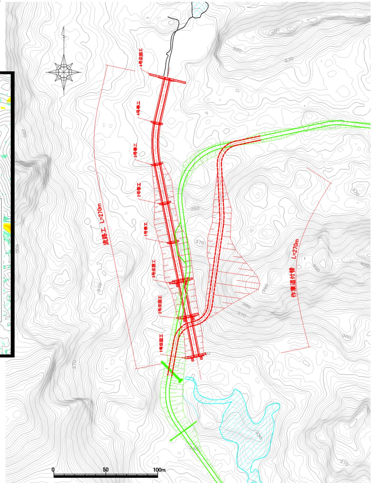
図 2.43 地すべり地内右岸流路沿い（上流部）の対策工のイメージ図
