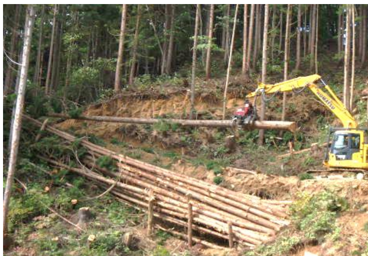
林業機械による造材作業
