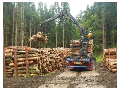
R8 小運搬巻立（丸太のはい積み）作業
