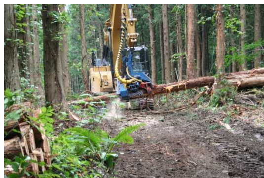
ハーベスタによる間伐材の造材
