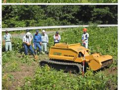
今回の現地検討会では、下刈作業の軽労化・省力化を実現に向け、高性能林業機械(リモコン操作式下刈り機)による下刈り作業の効果を確認するためのデモンストレーションが行われました。使用された機械はハイドロマチック・モア(写真の機械)という刈払い機で、リモコン操作により35度の急斜面での作業や機械高を変えて伐根を乗り超える機能を有し、踏破力に優れた機種です。
