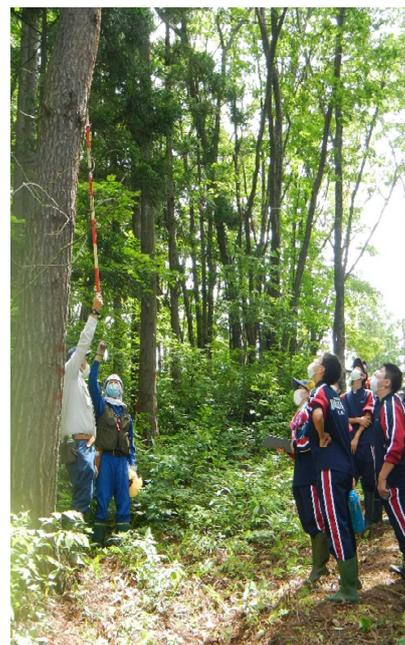
測樹作業では、輪尺と測竿を使って5本の供試木の直径と高さを計測し、野帳に記入する作業を行いました。輪尺の使い方では、2cm括約で目盛りを読み取ることや、胸の高さで計測することを学びました。測竿を使った樹高の計測では、少し離れた位置から測竿と樹高を比較してみることをコーチから指導を受けるなど、どの生徒も真剣に取り組んでいました。
