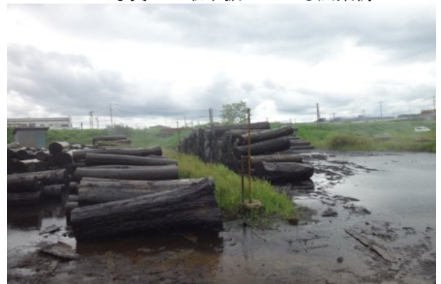
写真2：生木に近い状態を維持（地下水散水）
