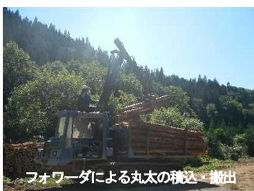
フォワードャによる丸太の積込・搬出
