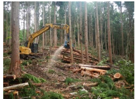
高性能林業機械を活用した間伐
