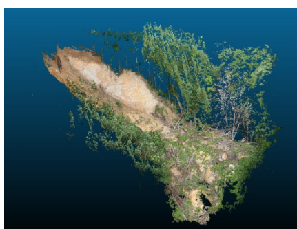
三次元点群データによる崩壊地調査
