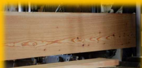
4mの梁材として製材
