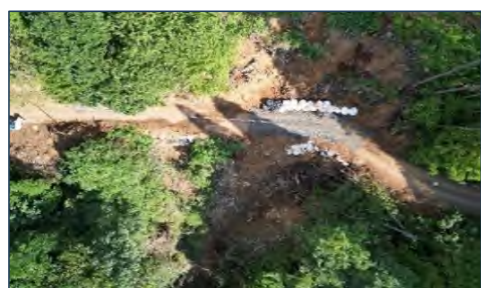
仁別林道起点から1.4km地点 (以降同じ) 道路側面崩落 L=34.0m
