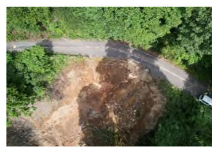
2.7km地点 道路側面崩落 L=34.0m
