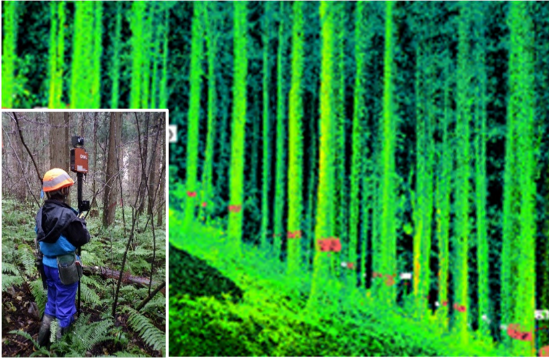
地上型3Dレーザスキャナを用いて収穫調査を効率化 写真の緑色は取得したデータで作成した三次元点群表示
