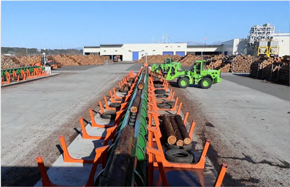
直送システムの導入（原木選別機による丸太の仕分け）
