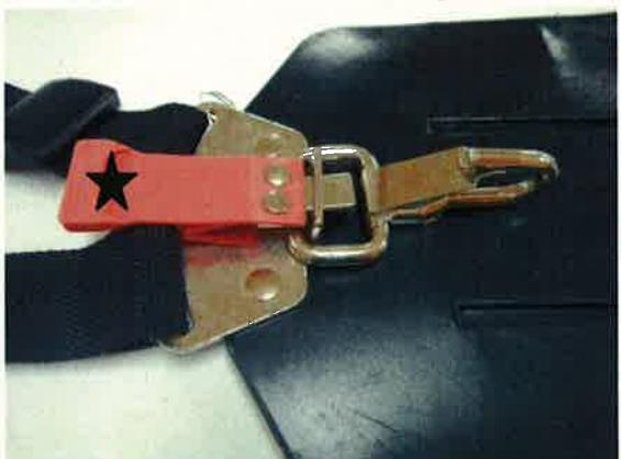
図3 緊急離脱装置（離脱前）
