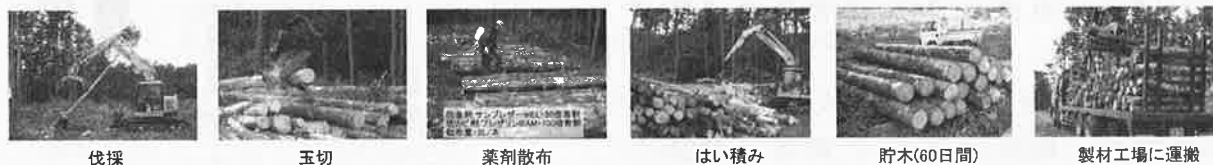
写真1 青変防止処理(薬剤散布)
