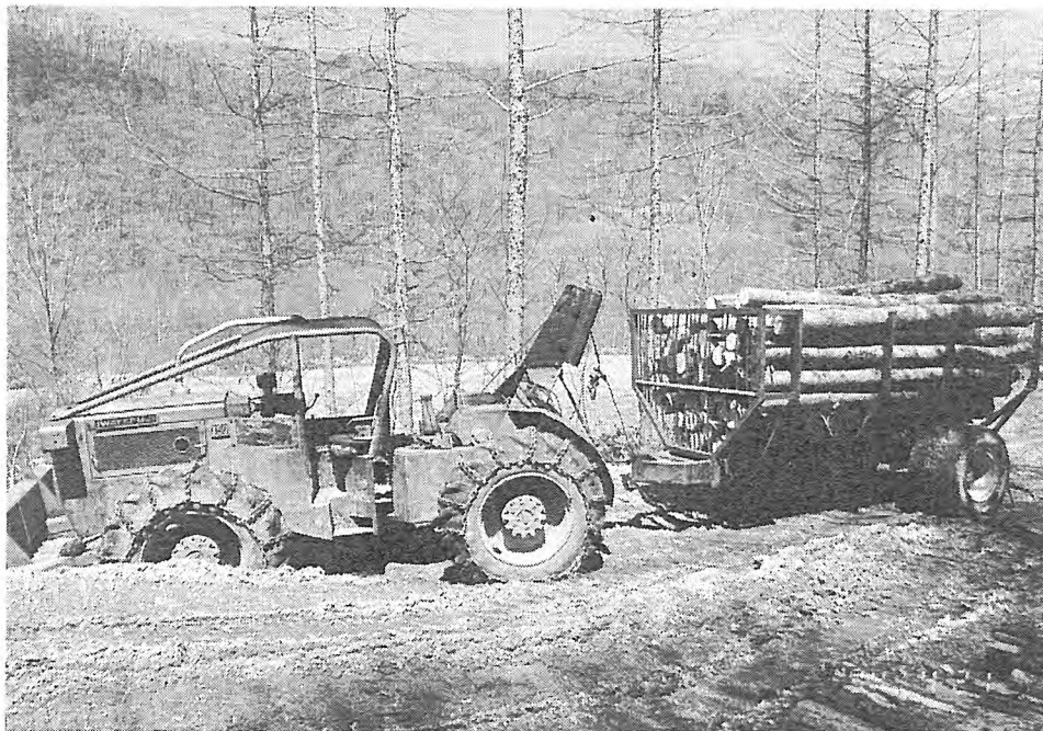
写-2 運材車による集材状況
