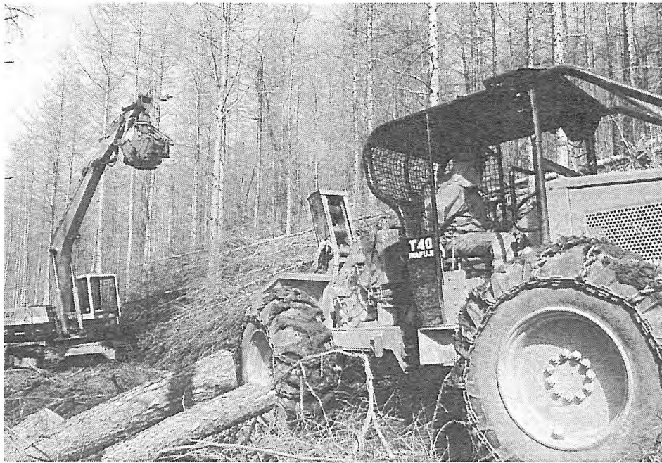
写-1 ハイリード方式による集材（引出し）状況
