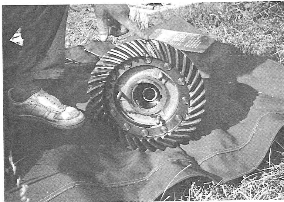
写-2 ギャーが破損した状態です
