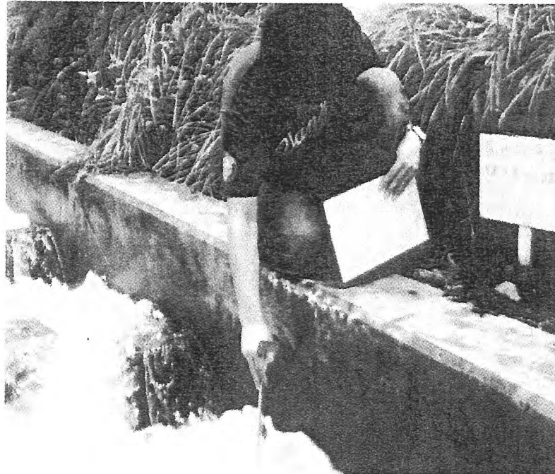
魚道内水温の調査状況 スライドNO.24
