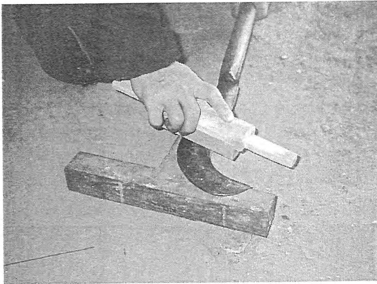
(写真-4 ホルダー付砥石の使用状況)
