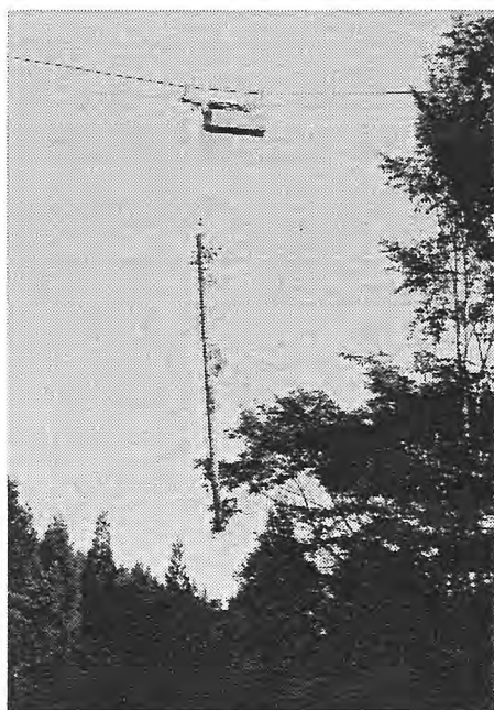
写真-3（スカイキャリアー による全幹集材）
