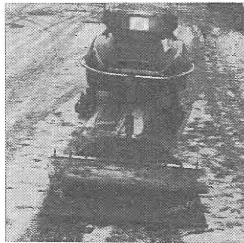
(写真-6) 取り付けした荷台とバックけん引装置
