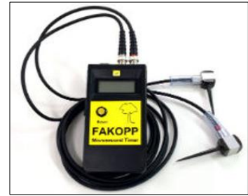
図1 FAKOPP 応力波伝播速度測定器
