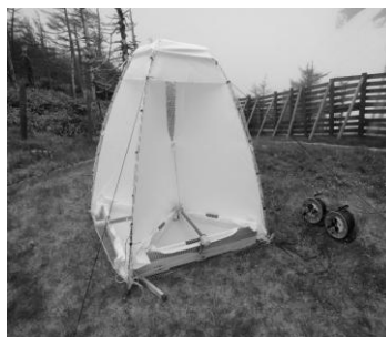
写真2 ライトトラップ (蛍光灯4本タイプ)
