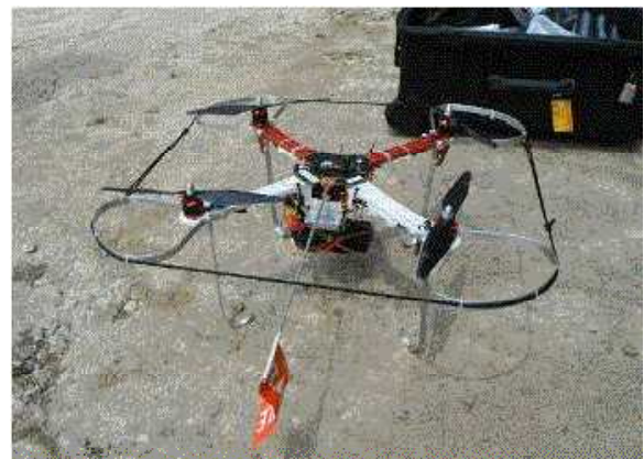
写真3. 小型電動マルチコプター (F450)
