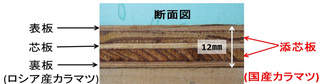
図 2 国産針葉樹型枠用合板の断面図
