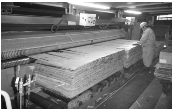
(写真 4) 素材を構造用合板に加工
