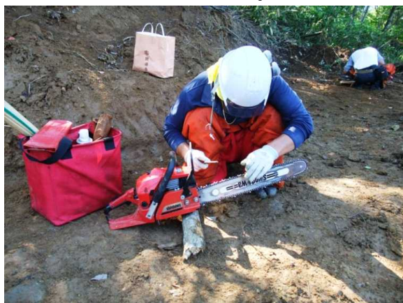
写真－1 現場における目立て作業
