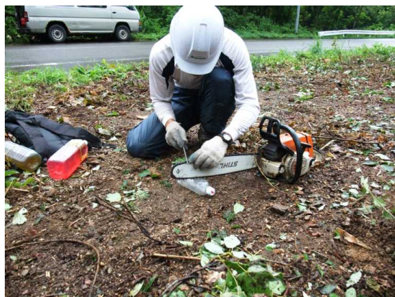
写真－1 現場における目立て作業
