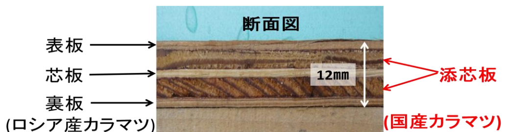
図 2 国産針葉樹型枠用合板の断面図
