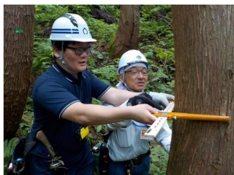
写真3 輪尺を用いた胸高直径の測定
