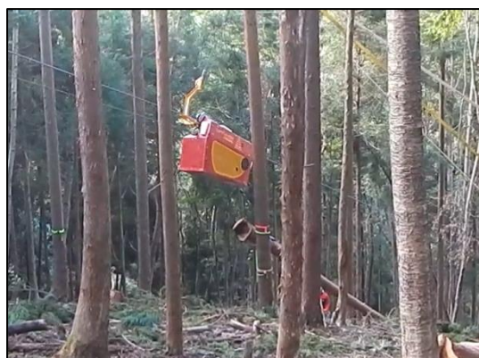
図7 中間サポート通過時 減速する搬器
