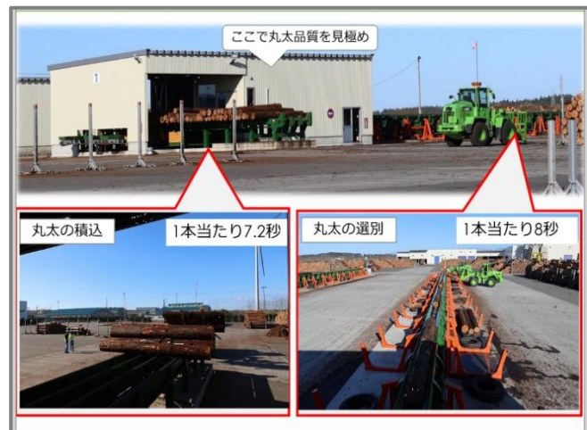
図-5 自動選別機の工期調査
