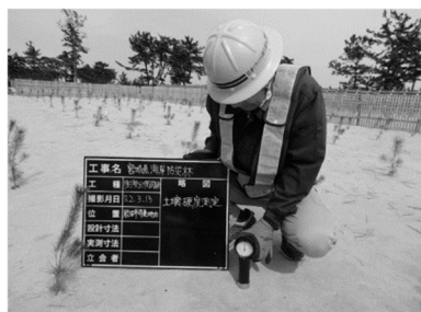
図2：土壌硬度の計測
