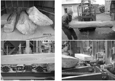
12月に五所川原市金木町にある「有限会社なかにし」さんをお願いして、ウルシの材を製材してもらうことにしました。浄法寺の小西美術工芸社から購入したウルシ材3本から、柎用の材料となる角材が6本とることができました。この角材を3Dターニングマシーンに掛けて柎を作ろうというのです。この機械は、丸鋸と電動ドリルを組み合わせた簡単な機械ですが、1400万円したそうです。丸鋸で外観を削り、電動ドリルで掘削し
