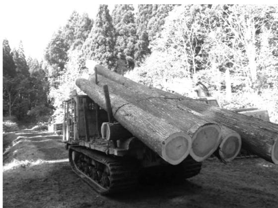
図 2 フォワーダによる搬出作業
