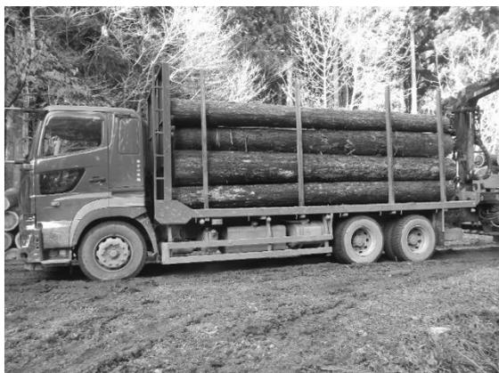
図 3 6 m 材の積載状況
