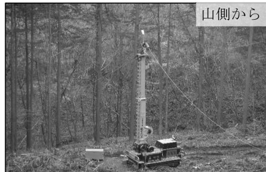
図9 タワーヤードの設置状況
