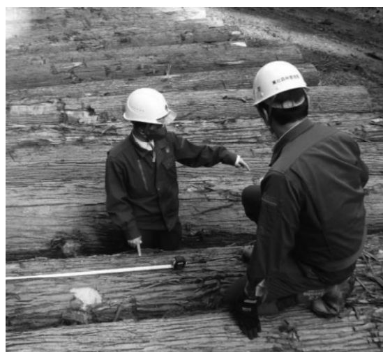
図12. 曲がり等の欠点を確認する様子
