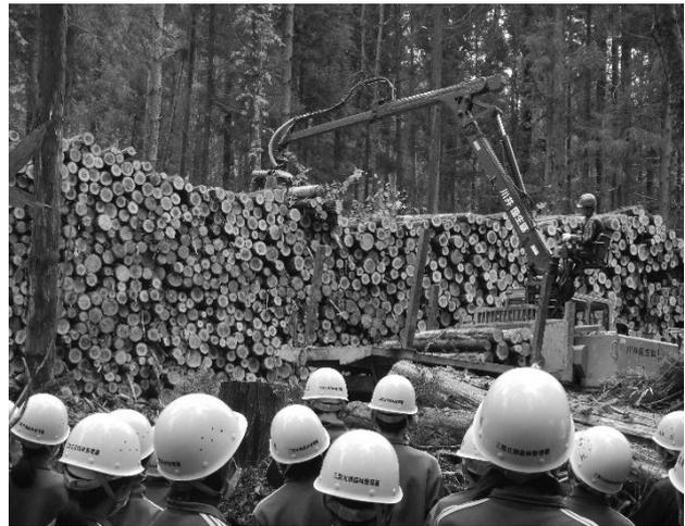
(写真-10) 高性能林業機械による巻立の様子
