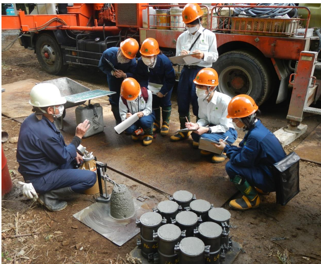
写真1：土木のOJT（スランプ試験の説明を受けている様子）
