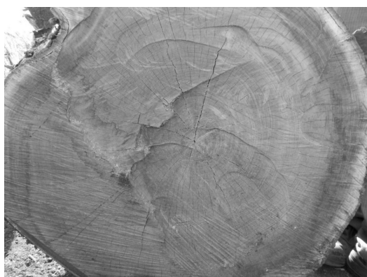
写真1 木取り不可能な材 （全体的に割れている）
