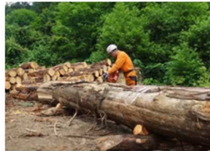
不要な枝を除去し適切な長さに切り分けて丸太に加工している様子。
