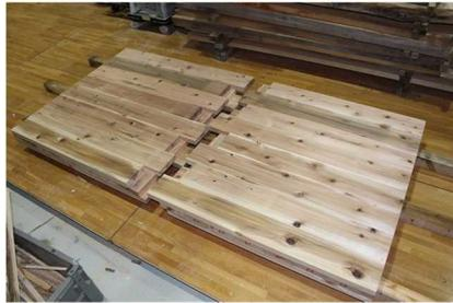
図-4 凸凹 CLT の開発
