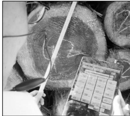
図2 径級音声入力
