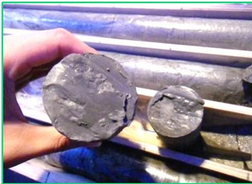
写真 3. 109m 集水井 すべり面の痕跡
